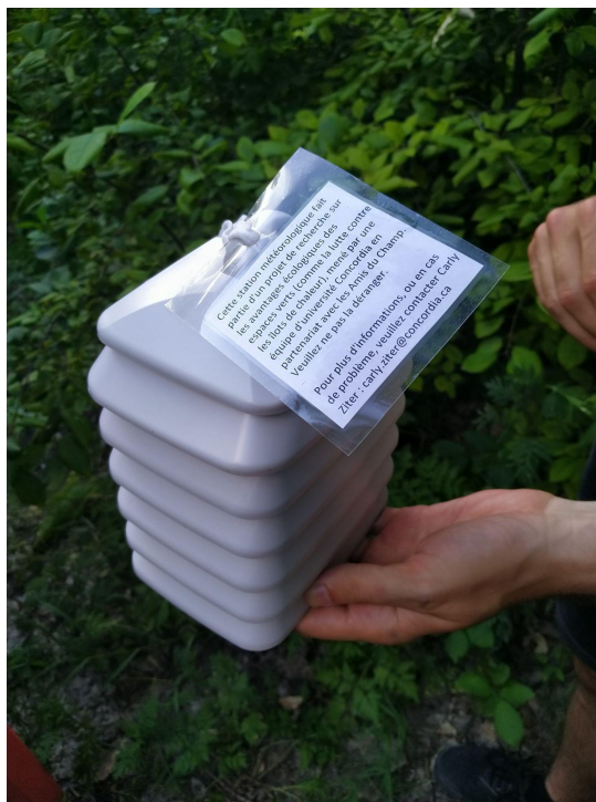
Un capteur de température installé dans le CDP pour étudier les îlots de chaleur urbain (26 octobre 2022)
